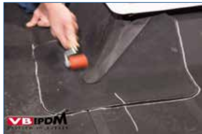
126. Anrollen des verklebten Formteils.
