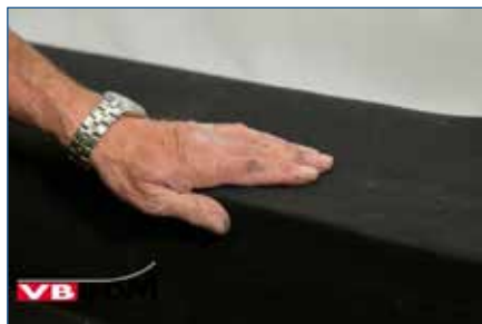
151. Ploovrij aanvegen lijmdeel met vlakke hand.
